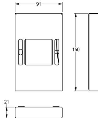
Hygienebeutelspender für Aufputzmontage, Chromnickelstahl, Oberfläche seidenmatt, Materialstärke 0,8 mm, innenliegende Haltetasche, Entnahme der Hygienebeutel von vorne, Montage durch umseitig vormontiertes doppelseitiges Klebeband oder beiliegenden Edelstahlschrauben und Dübel möglich, inklusive Acetontuch zur Reinigung der zu beklebenden Oberfläche.
