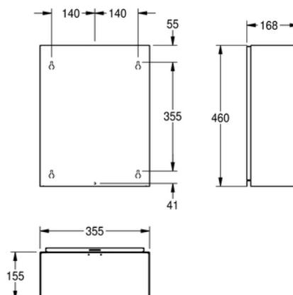
Abfallbehälter für Aufputzmontage, Chromnickelstahl, Oberfläche seidenmatt, Materialstärke 0,8 mm, Oberkanten gesäumt, Fassungsvermögen zirka 23 Liter, Montage wahlweise mit Montageleiste oder direkt auf die Wand, inklusive Edelstahlschrauben und Dübel.
