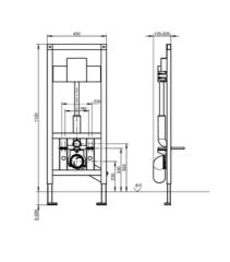
AQUAFIX-Installationselement für wandhängende WC-Becken, mit vormontiertem Armaturen-Rohbauset für Wandeinbau-WC-Spülarmaturen AQUALINE / PROTRONIC / AQUATIMER. Selbsttragende, pulverbeschichtete Stahlrahmenkonstruktion, TÜV geprüft, zur Einzelmontage für Trockenverkleidung, Befestigungsschelle 4-fach verstellbar für WC-Anschlussbogen DN 90 / DN 100, komplett mit Zu- und Ablaufgarnitur, Haltebolzen für WC, Bauschutz und Befestigungsmaterial.
