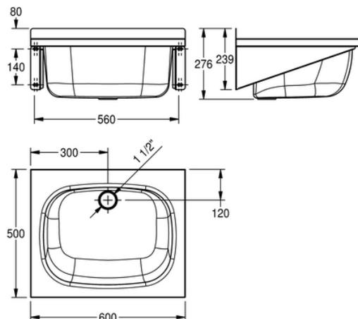
Mehrzwecktrog für Wandmontage, aus Chromnickelstahl, Oberfläche seidenmatt, Materialstärke 1,0 mm. Fugenlos eingeschweißtes Becken, mit abgerundeten Kanten. Mit Armaturenbank 70 mm, hintere Aufkantung 40 mm (H), Ablauf hinten mittig, Standrohrventil G 1 1/2 B. Inklusive Konsolen und Befestigungsmaterial.
