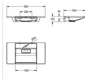
Einzelwaschtisch aus kunstharzgebundenem Mineralwerkstoff MIRANIT mit porenfreier, glatter Gelcoatoberfläche in Hochglanz (temperaturbeständig bis 80°C) mit Ablageflächen und angeformter Konsole für die Wandmontage. Mit einer nahtlos eingeformten Mulde, ohne Überlauf und einer abgesenkten Armaturenbank mit Armaturenbohrung. Inklusiv Befestigungsmaterial, Sieb Ablaufventil DN 32, diebstahlgesicherter Ablaufabdeckung mit InoxPlus Beschichtung. Farbton Alpinweiß.
