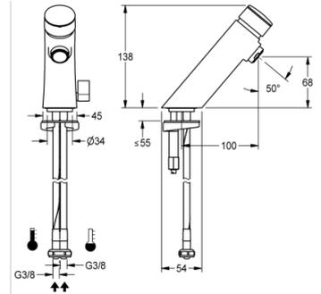
F3S-Mix Selbstschluss-Standbatterie DN 15 für Waschanlagen.
